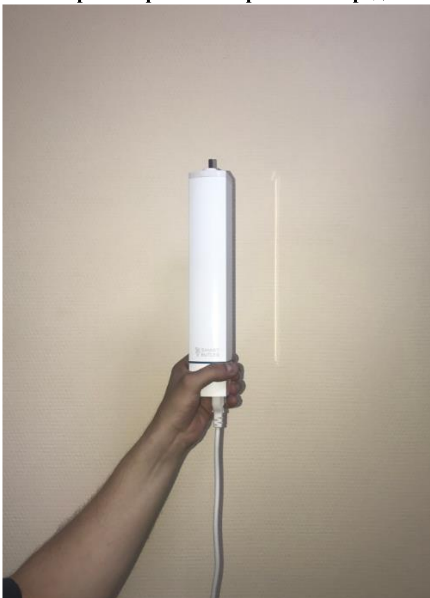
Рис. 5 Измерение уровня шума электромотора в изолированной среде (сейфовая комната офисного помещения Союза «Федерация Судебных Экспертов»)
