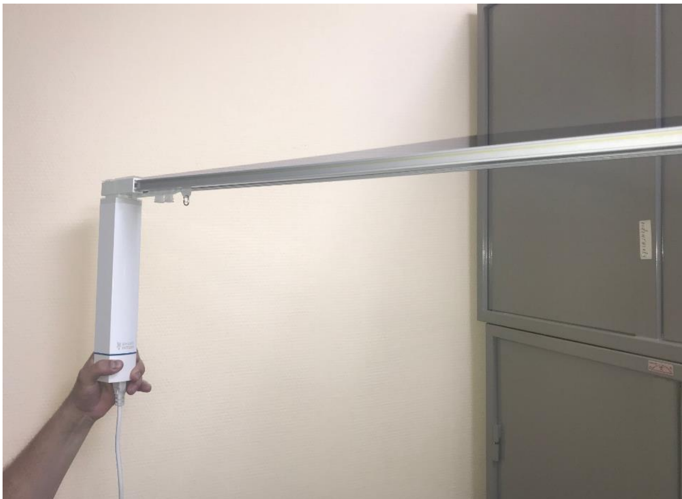
Рис. 6 Измерение уровня шума электрокарниза в сборе в изолированной среде (сейфовая комната офисного помещения Союза «Федерация Судебных Экспертов»)
